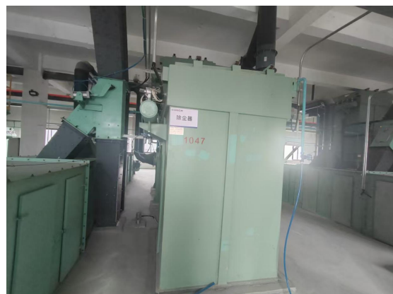
石灰石仓顶 2#及转运 1#袋式除尘+34m 排气筒（DA017）
