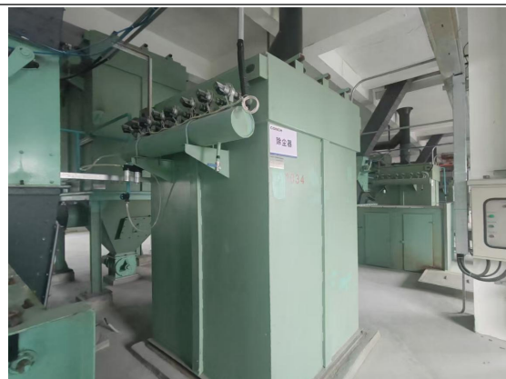
石灰石仓顶 2#及转运 1#袋式除尘+34m 排气筒（DA017）
