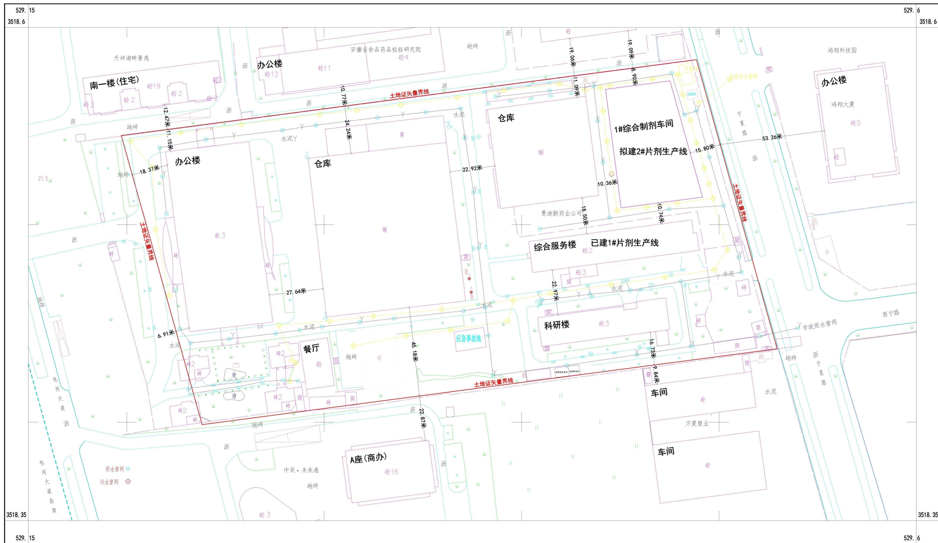
合肥英太制药有限公司雨污分流管网图（蓝色为雨水管网，黄色为污水管网）
