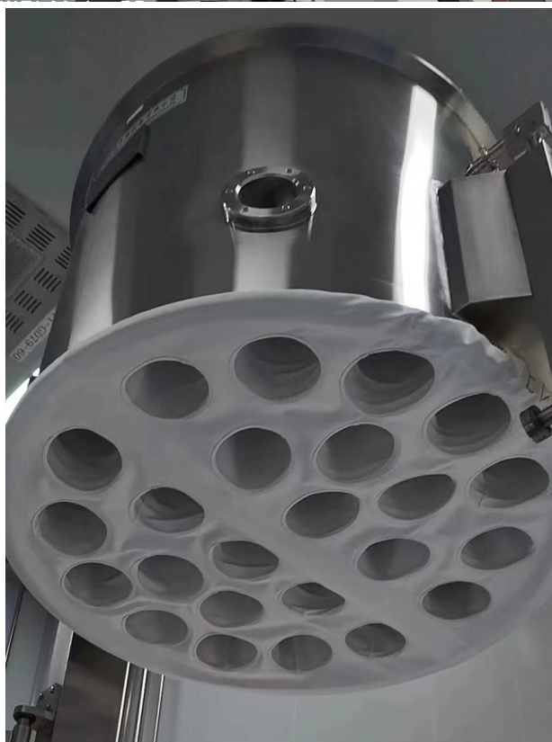
2#片剂生产线 2#沸腾干燥机袋式除尘器及其排气筒 DA005
