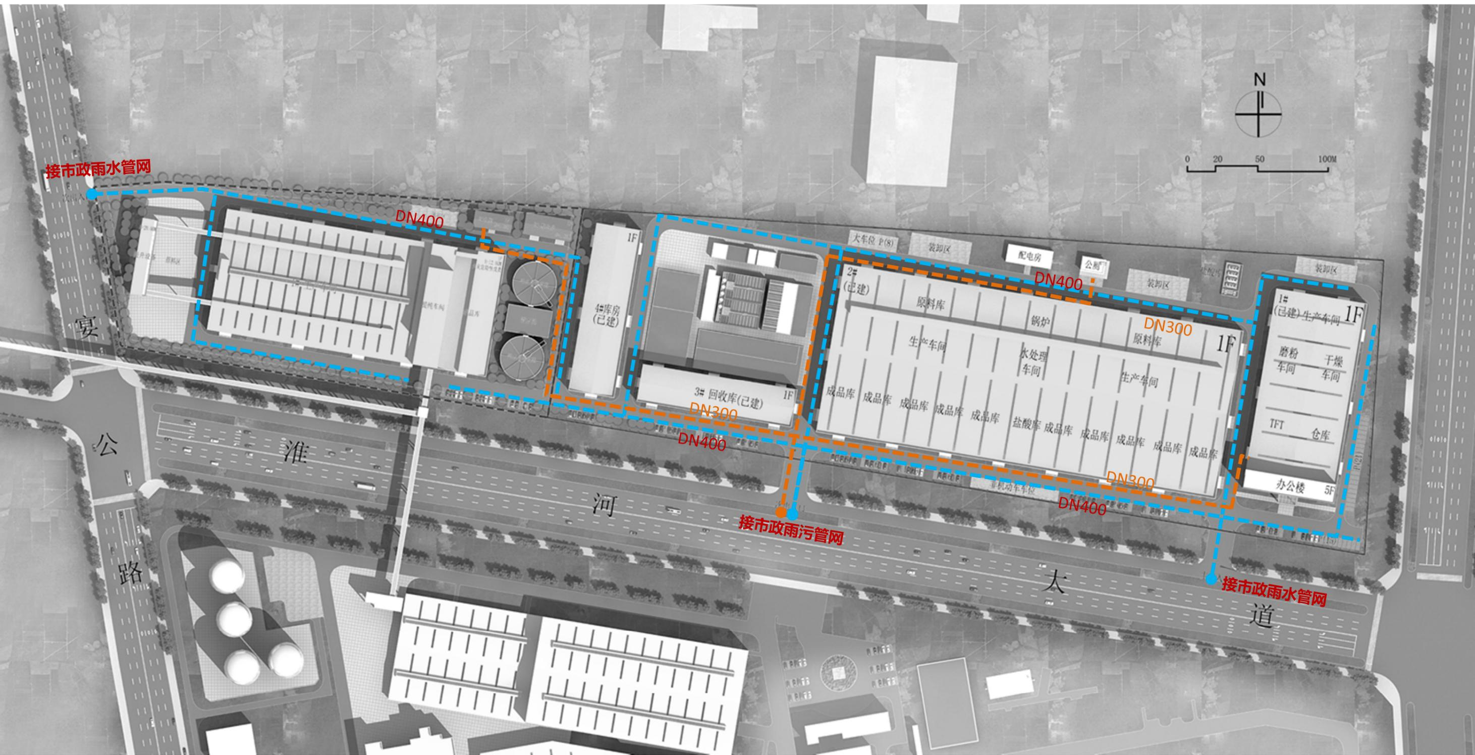
附图5 全厂雨污分流管网图
